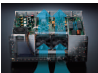
Die beiden Ventilatoren liegen hinter der Frontplatte
