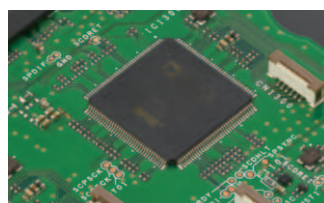
DSP für das Bandskop ADSP-21363, Takt 332 MHz
