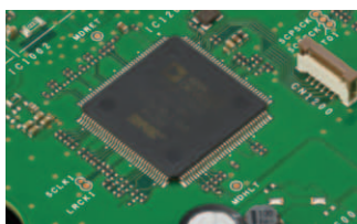
ZF-DSP des Senders ADSP-21363, Takt 332 MHz
